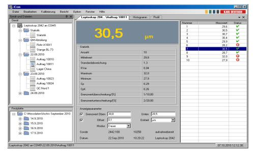
Bedienoberfläche von **iCom** (im Beispiel: LEPTOSKOP 2042) mit Dateiverwaltung im Messgerät und PC, Messparametern und Messwertliste. Im linken oberen Fenster wird die Dateistruktur des Messgeräts angezeigt. Der aktuelle Speicherbereich auf der PC-Festplatte ist links unten zu sehen. Über einfaches Markieren und Ziehen (drag 'n drop) können Gerätedateien zum PC kopiert werden.
